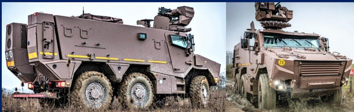
**Le Griffon est un véhicule blindé a roue développé dans le cadre du programme « Scorpion ». C'est un VTT (Véhicule de Transport de Troupe) destiné à remplacer l'actuel VAB (Véhicule de l'Avant Blindé), désormais dépassé. Il est équipé de toutes les dernières technologies indispensables aux combats d'infanterie.**
